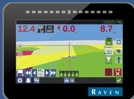
CR7™ est une console compacte et légère qui dispose d'une interface personnalisable. Le concept de widget permet de configurer la page de travail en fonction de l'utilisateur ou du travail à faire. Dotée des fonctions ISOBUS terminal universel et contrôleur de tâches, CR7™ est une console polyvalente que vous pourrez utiliser pour tous vos travaux.
