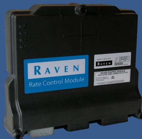
Le RCM prend en charge une grande variété d'applications : il peut contrôler jusqu'à 5 produits liquides ou solides, dont le NH3 (avec AccuFlow™ HP+) Il est adapté aux pulvérisateurs, semoirs pneumatiques, monograines à entraînement hydraulique ou électrique, embrayages de coupure de rang, niveau de trémie, contrôle de rotations, pesée... Le contrôle des tronçons jusqu'à 16 tronçons permet de limiter les coûteux manques et chevauchements.
