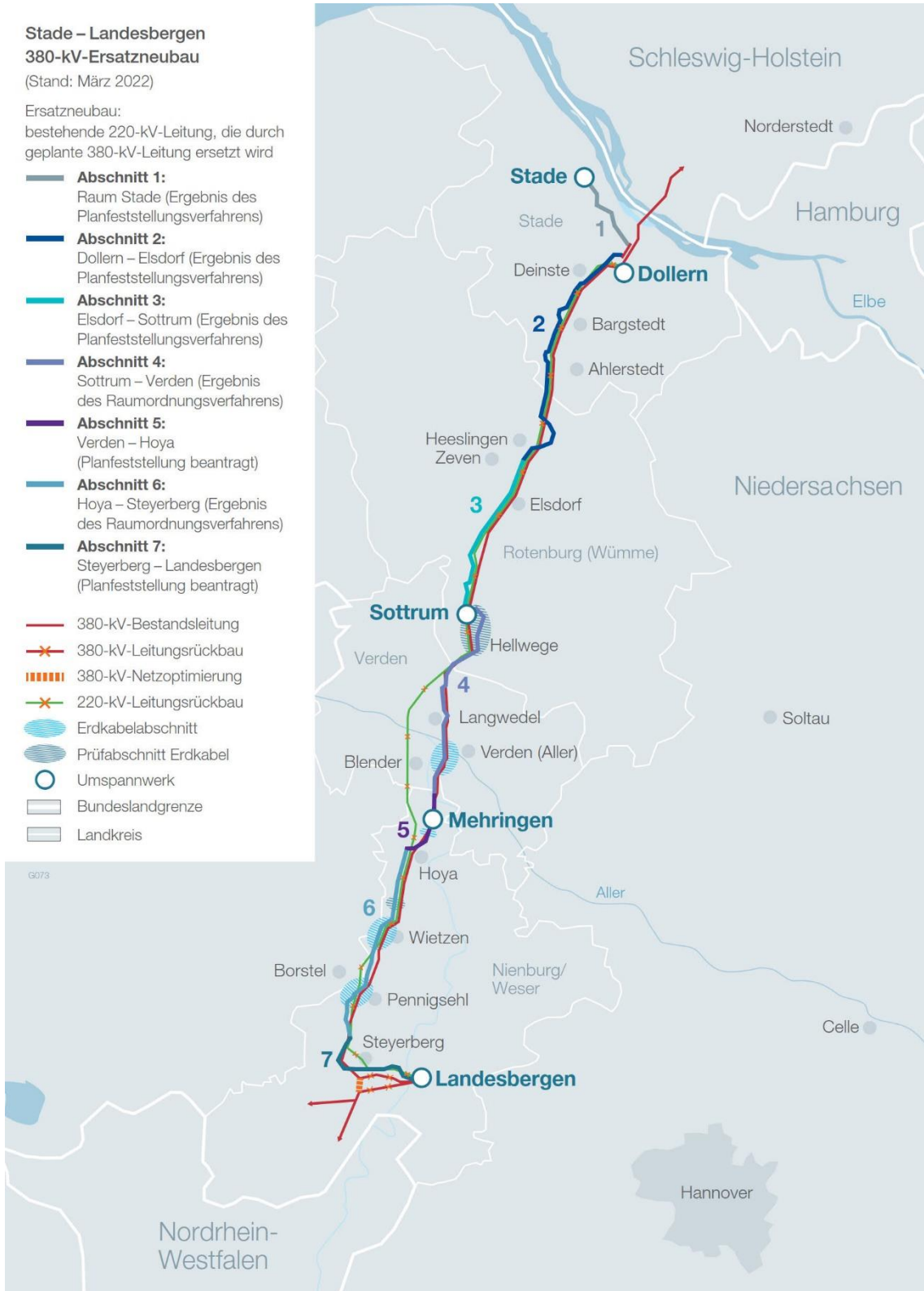
Abbildung 1: Planfeststellungsabschnitte (Quelle: TenneT TSO)
